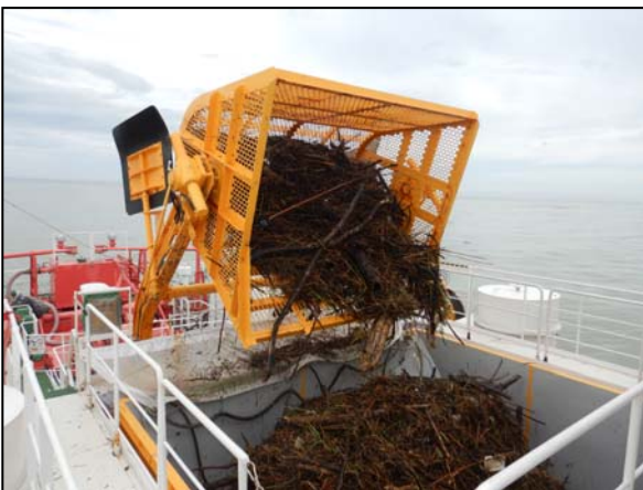
「白龍」のスキッパー(※写真中央黄色のかご)により海面からすくい取られた流木等 (7月11日)
