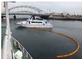
オイルフェンスによる漂流物の囲い込み
