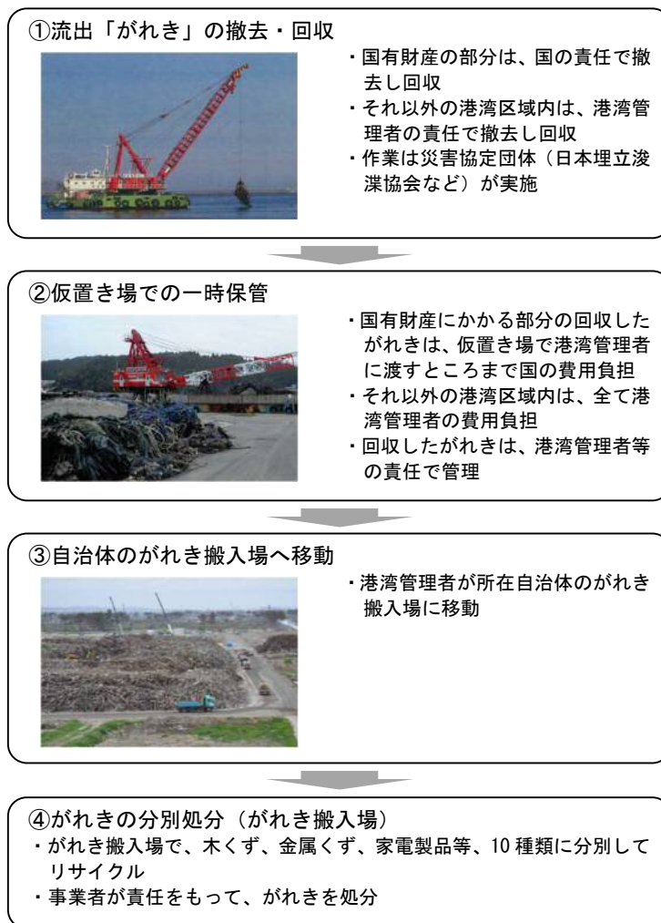
図 30 水域に流出した「がれき」の撤去～処分に至る役割分担
