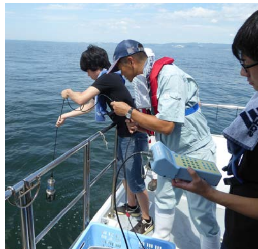
水質調査（水温、塩分、溶存酸素、クロフィル）
