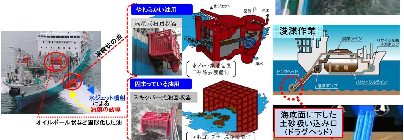
油回収タンクに約1時間で1,000kl (ドラム缶約5千本分)の油水を回収可能。
