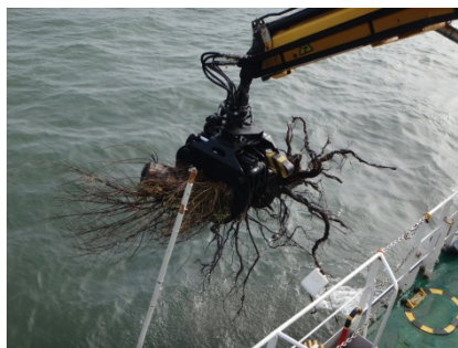
流木根の回収状況
