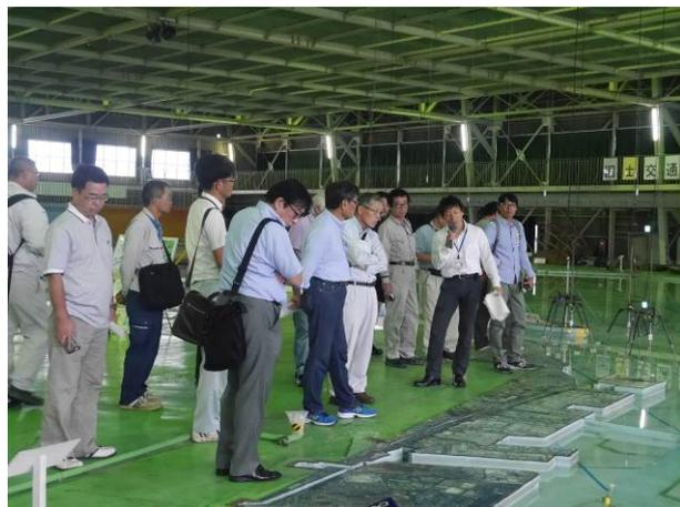
平面水槽での防波堤効果実験
