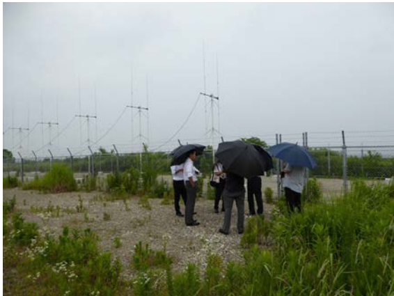
【名古屋港 津波観測にも利用可能な海洋短波レーダーを視察】
