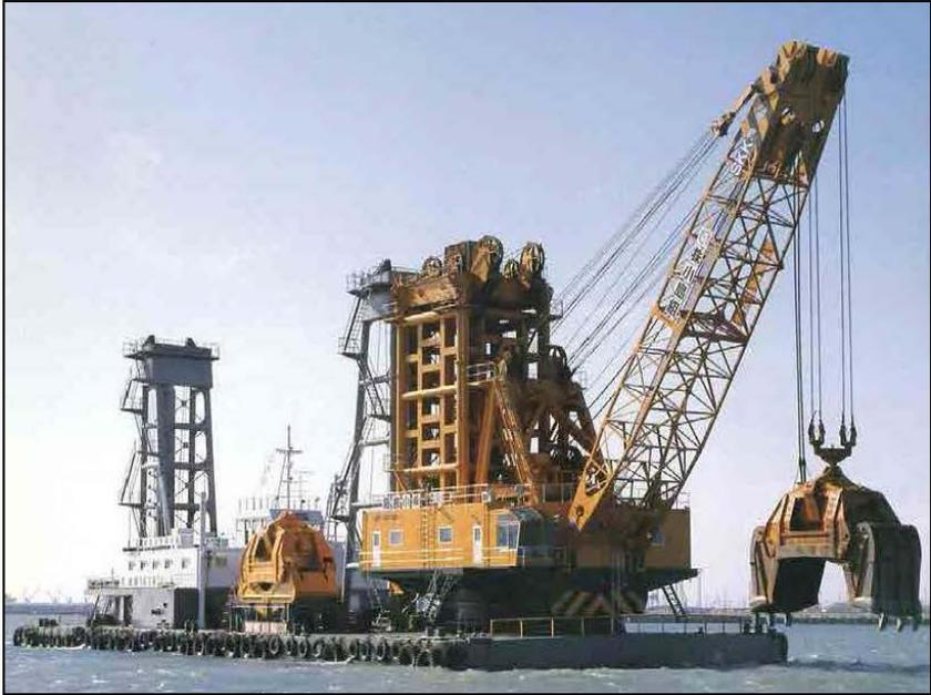
一回で10トンダンプトラック 約4台分の土砂を掘ります
