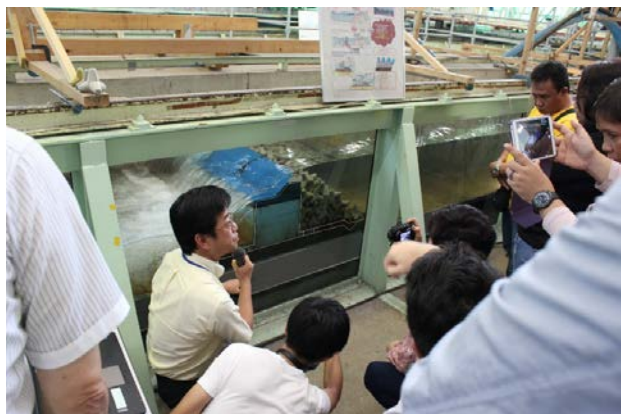
長水路水槽での津波実験
