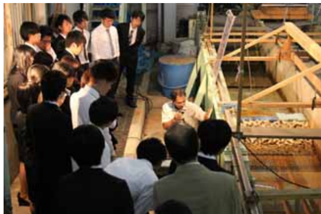
長水路水槽における防波堤津波実験
