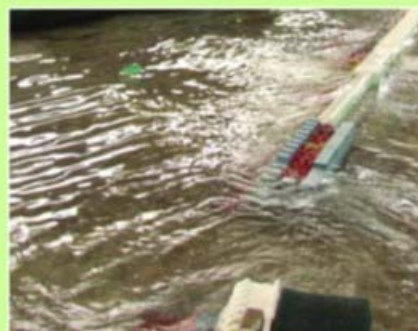
平面水槽 防波堤安定実験
