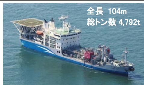
浚渫兼油回収船「清龍丸」 （名古屋港湾事務所所属）
