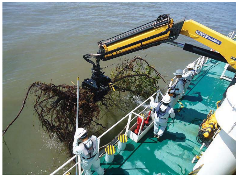
多関節クレーンによる流木の回収
